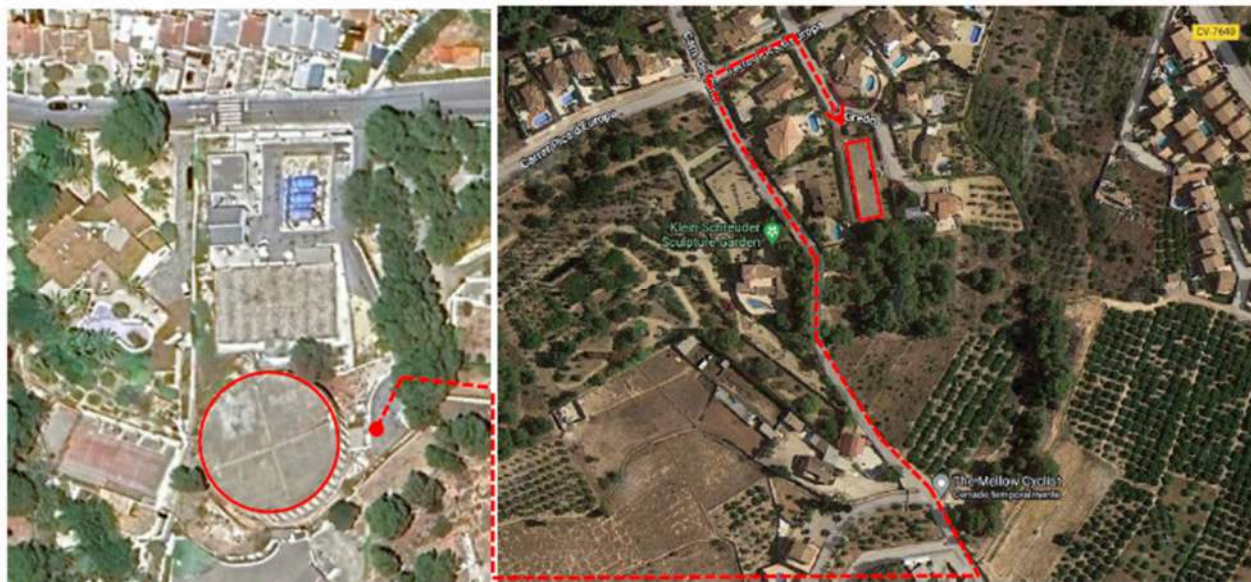
Fotografías aéreas de los depósitos de Salida y Llegada de la impulsión o aducción que deberá sustituir el suministro del Obturador de Carbonera/Cautivador.
